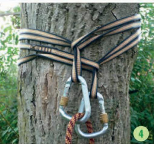
1. Obere, redundante und gegenläufige Umlenkung mit separater Notschnur
